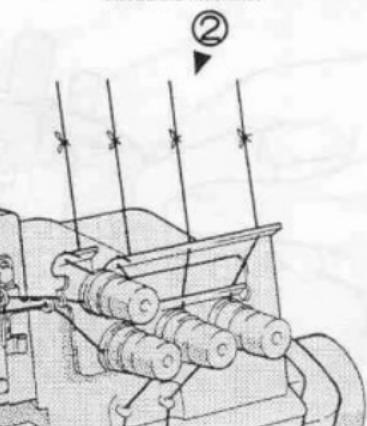
② Die Einfädelung der Maschine gemäß Einfädeldiagramm überprüfen.
